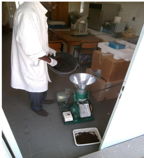
La machine à Pellets
