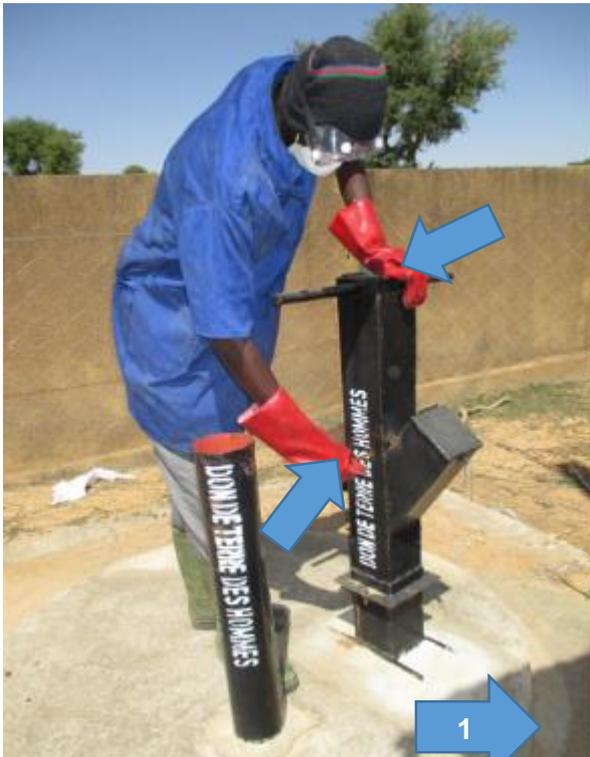
Déverrouiller la manivelle du crusher.
