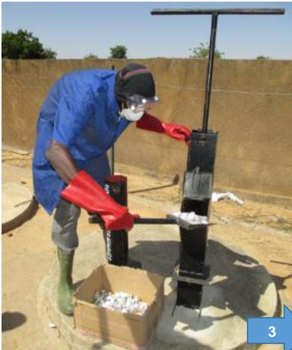
3 Introduire en petite quantité à travers l'entonnoir, les flacons en bouteilles et débris de verres dans la chambre à moude.
