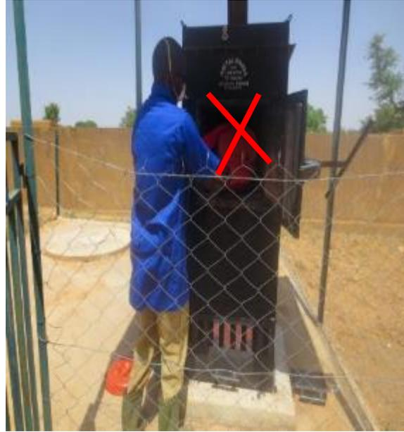
1. Ne pas déverser les déchets dans la chambre à combustion sans l'avoir réchauffée
