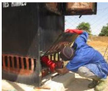
**Etape 4 : réchauffage de la chambre de combustion**
