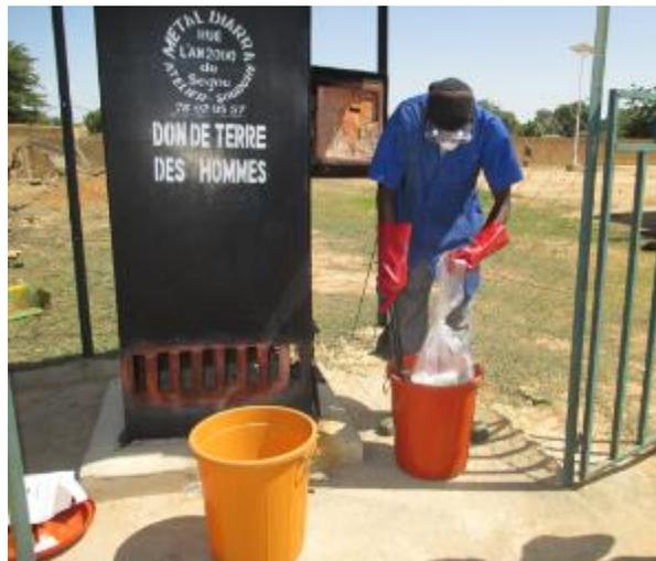
Introduire dans l'incinérateur les déchets de la poubelle rouge (scellés), jusqu'à 75% de ses capacités. Ces déchets sont plus mouillés et ne pourront être totalement incinérés qu'à une température élevée. L'incinération doit suivre l'ordre chronologique: poubelle jaune et rouge. Les déchets de la poubelle jaune sont plus facilement combustibles que ceux de la poubelle rouge, ils attirent davantage la chaleur et facilite l'incinération des matières humides contenues dans la rouge.
