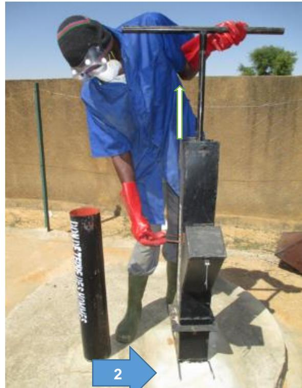
Retirer vers le haut la manivelle afin de libérer la chambre de réception des flacons et insérer le clapet de verrouillage pour maintenir stationnaire vers le haut la manivelle.
