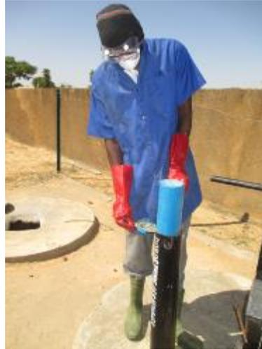
Retirer le disque de soutien pour déverser des aiguilles dans la fosse.
